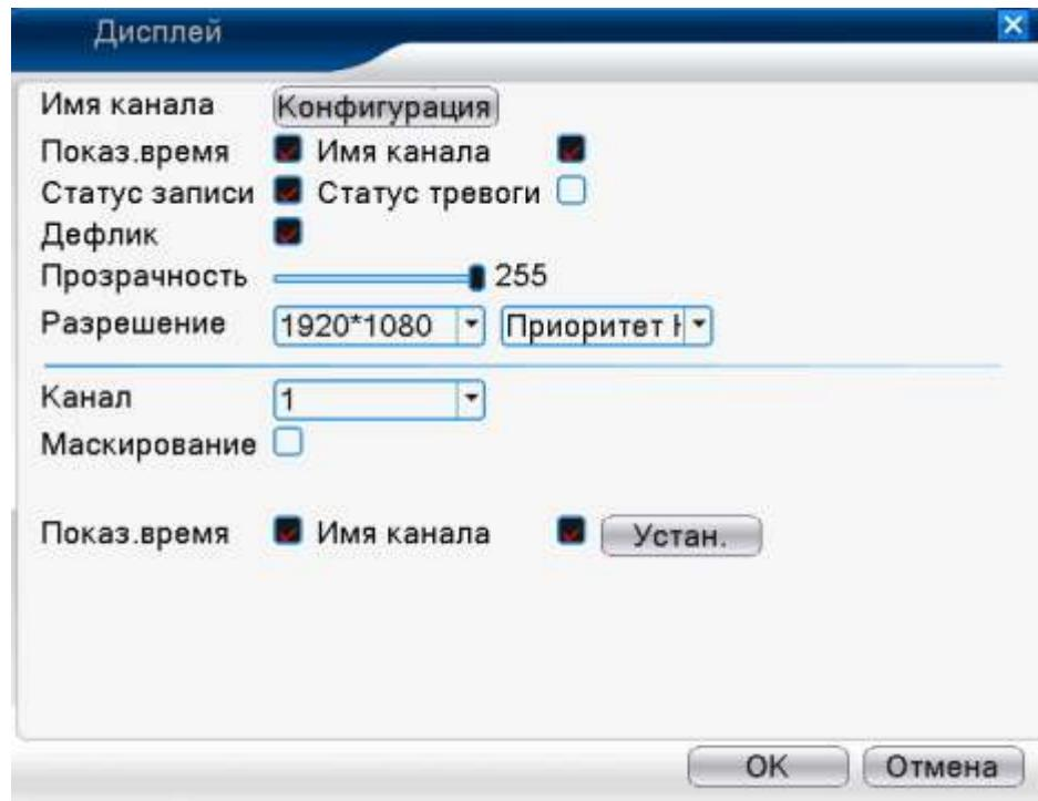
Вкладка графического дисплея в гибридном режиме (HVR) и всех аналоговых режимах (DVR)
