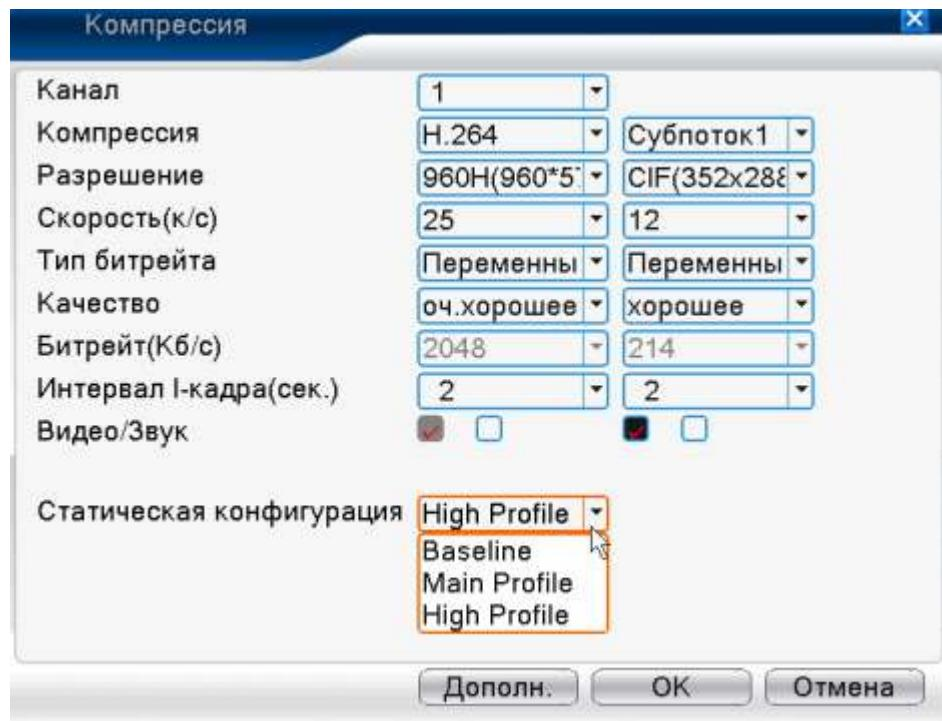
Рисунок 4.20 Настройка кодировки
