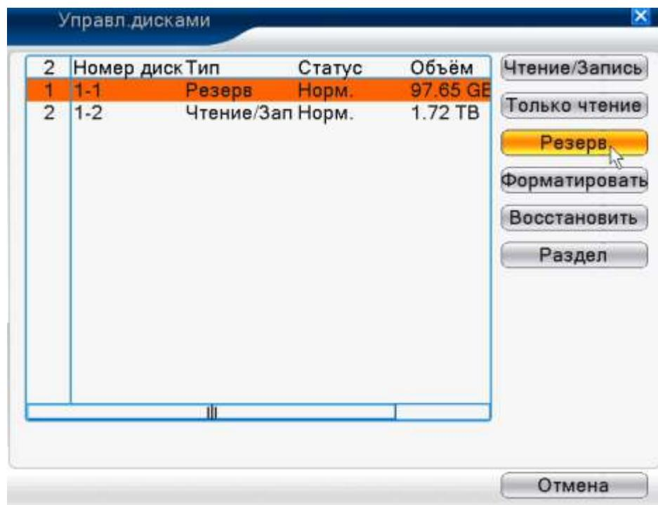
Рисунок 4.46 Управление HDD
