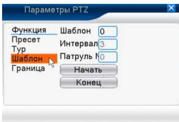
Рисунок 3.14 Установка сканирования
