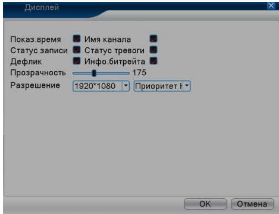
Вкладка графического дисплея для полностью цифрового канала (NVR)
