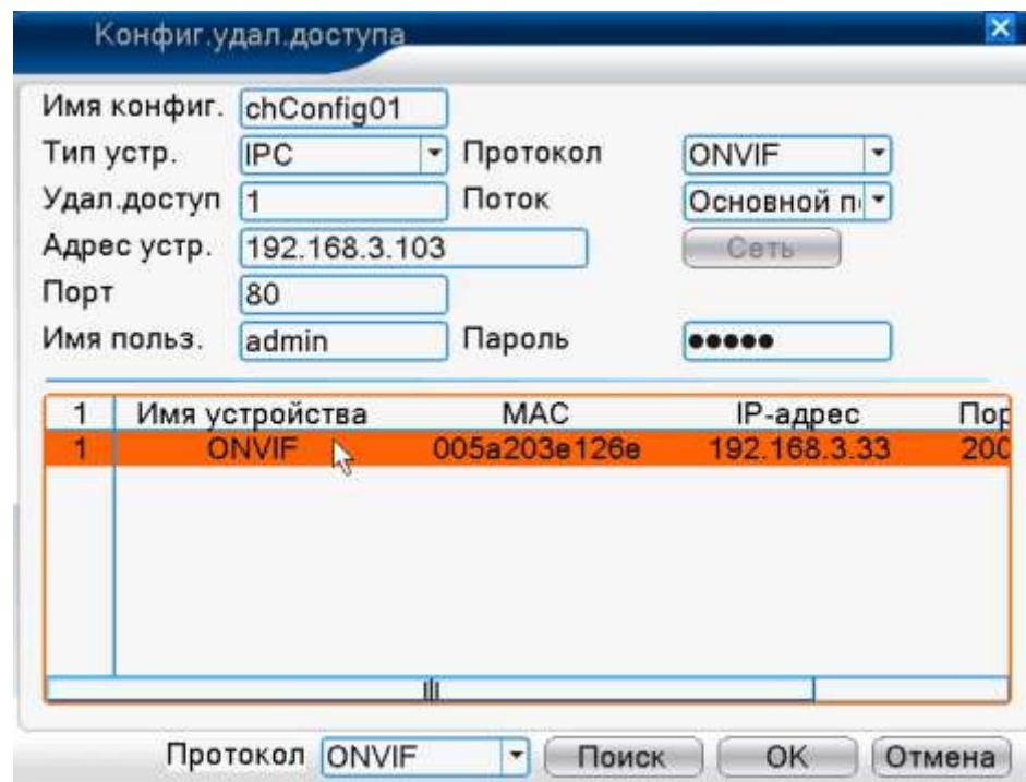
Рисунок 4.45 список запрашиваемых устройств в настройках удаленного канала
