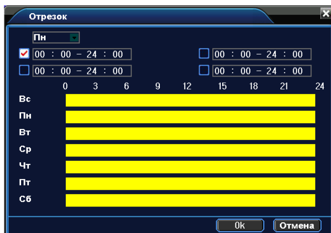
Рисунок 4.4 Установка интервала записи
