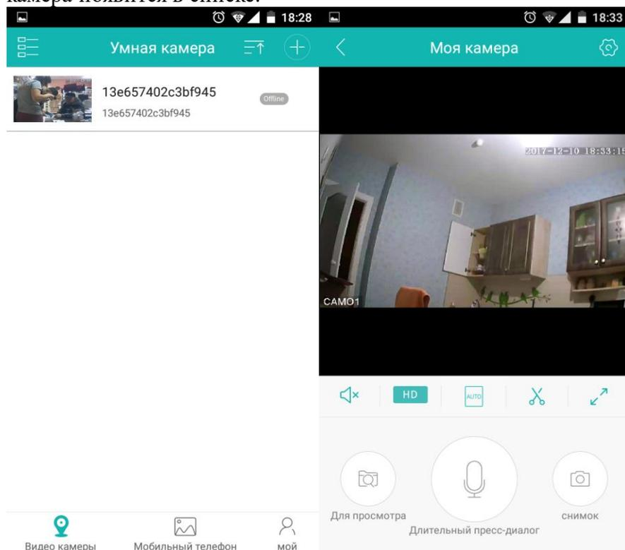
Для того, чтобы в той же сети добавить ту же камеру на другое мобильное устройство, устанавливаете программу, выбирайте на нём пункт **"Добавить камеру в LAN"** (с красной меткой):
