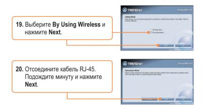
**<u>Примечание</u>**: Устройство TV-IP501W не будет производить беспроводное подключение до тех пор, пока не будет отсоединен кабель Ethernet от задней панели камеры.
