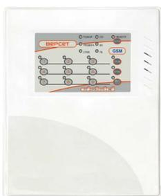
Являются универсальными многофункциональными приборами для обеспечения безопасности на объектах. Приборы имеют все необходимые средства для того, чтобы организовать охрану от проникновения посторонних лиц в охраняемое помещение, пожарную охрану, но и контроль доступа в помещение (проход в помещение на основе электронных ключей, проксимити карт, паролей), работу с технологическими датчиками и управление оборудованием, контроль температуры в помещениях и другие важные функции безопасности.
