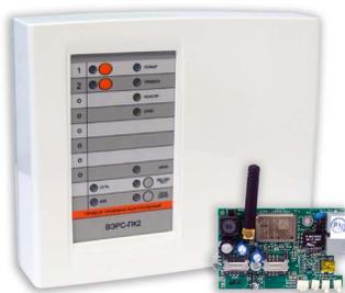
Предназначен для организации в офисах, квартирах, коттеджах, дачах, гаражах и других объектах пожарной сигнализации; охраны от проникновения; выдачи сигналов на технологическое оборудование; автоматического информирования пользователей по каналам GSM-голос, GSM-SMS, ГТС; автоматической передачи информации на мобильное приложение (платформы Android и iOS).
