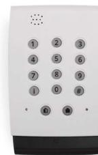
Компактная проводная панель с клавиатурой на корпусе: для постановки и снятия с охраны не нужны дополнительные устройства. Подключаются 4 проводных охранных шлейфа или дискретных выхода с возможностью увеличения до 16 за счет внешнего расширителя.
