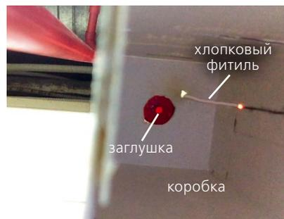
Рис. 4. Тление хлопкового фитиля в коробке (вид сверху)
