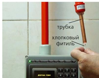
Рис. 5. Тление хлопкового фитиля в трубке  $\varnothing 10$  мм
