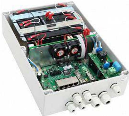
Рисунок 5. Коммутатор PSW-2G4F-UPS.
